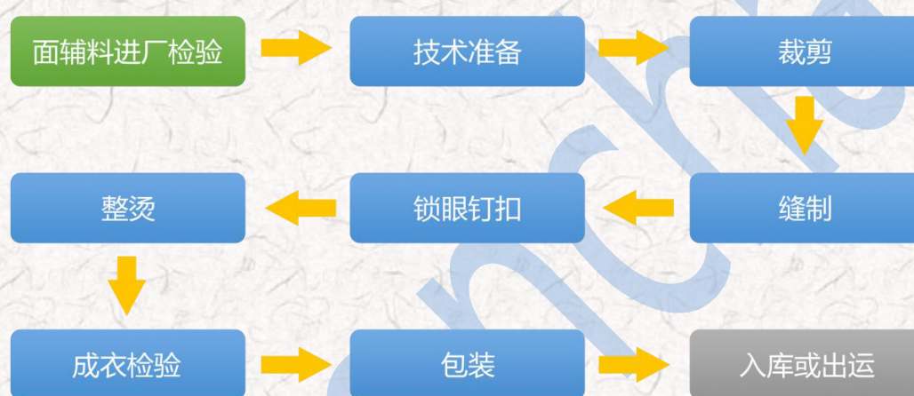
圖 2.9 傳統服裝生產加工流程示意圖
