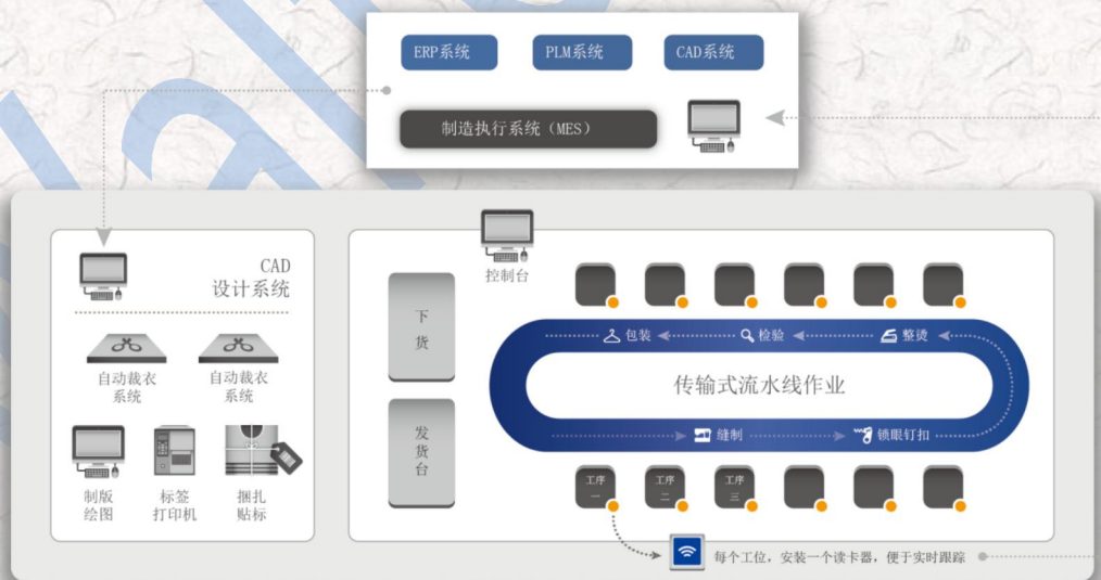
圖 2.11 基於 RFID 的智能化生產線結構示意圖
