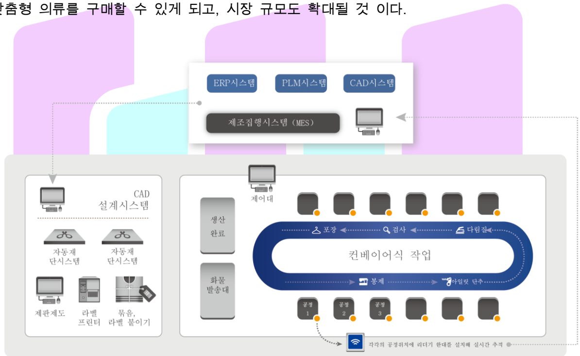
도면 2.10 RFID 에 기반한 지능형 생산라인 구조 예시
