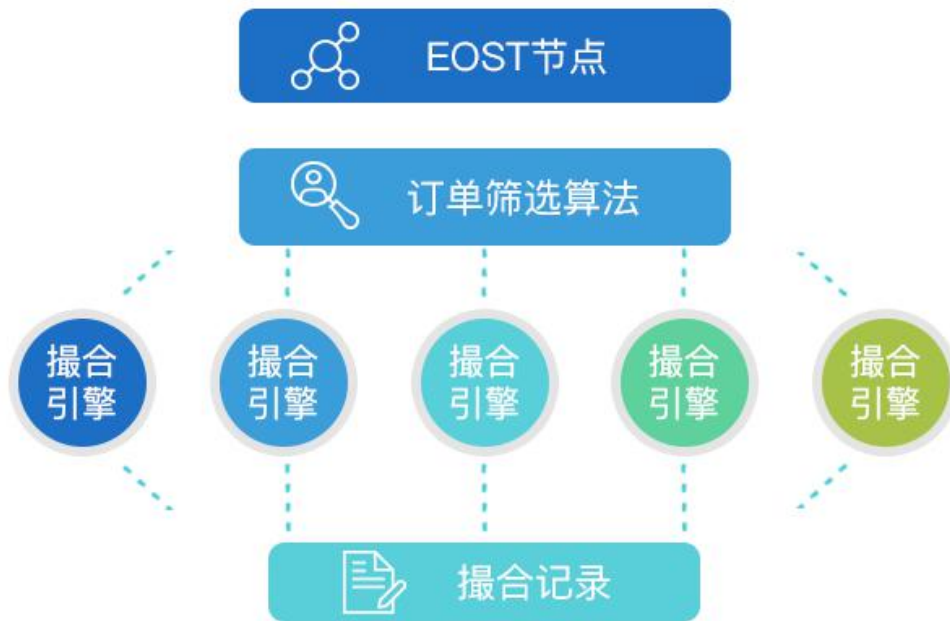
图 2 EOS-TRANSPORT 内存撮合系统架构图
