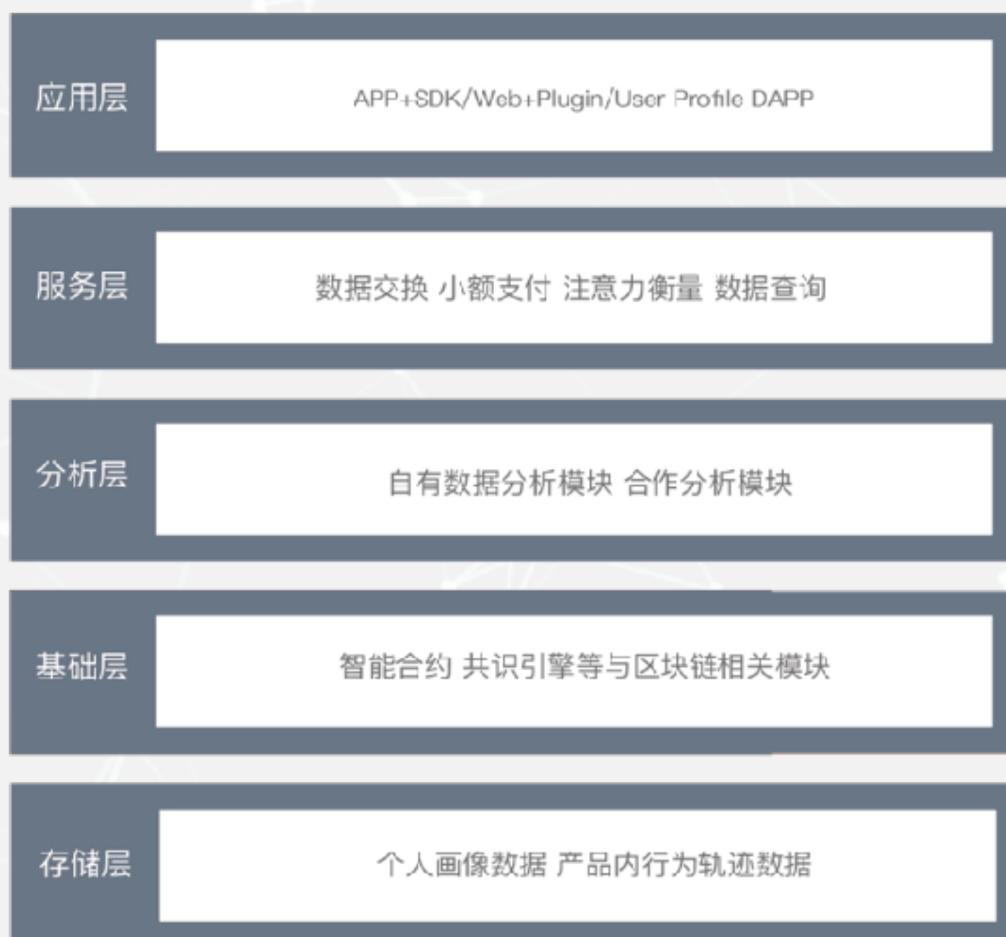
图八 - 质子链的结构分层
