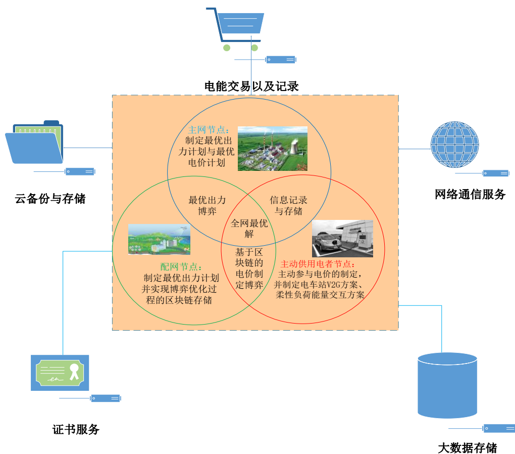
图 7：区块链在该模型中的应用以及各节点的存储分工
